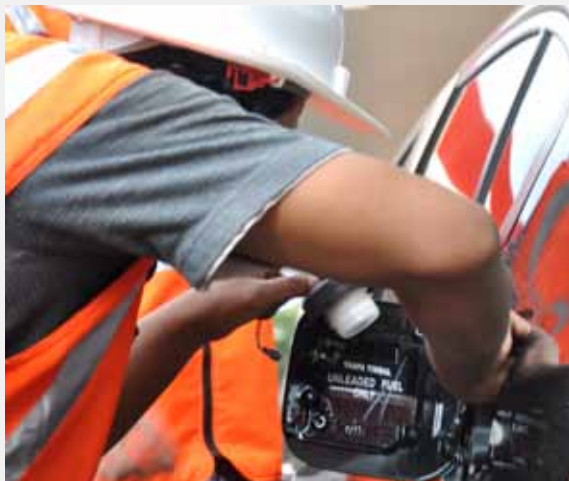
Proses Pemasangan RFID pada Kendaraan
